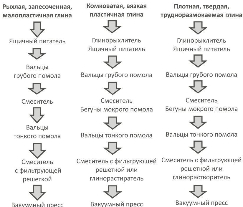
Рис. 3. Схемы переработки сырья при пластической схеме формования изделий [1]
