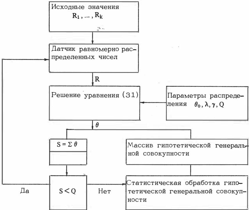
временно поступает в блок суммирования, где накапливается текущая сумма НГР. Затем накопленное значение НГР проверяется на превышение заданных НГР. Если такое превышение не достигнуто, то процедура возвращается на генерацию следующего равномерного числа. В противном случае полученная гипотетическая генеральная совокупность подвергается дальнейшей обработке: выдача на печать, запись во внешнюю память, расчет статистических характеристик.
