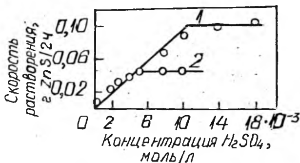
Рис. 5.5. Зависимость скорости окисления ZnS от концентрации серной кислоты при различных значениях парциального давления кислорода при температуре 100°C.
