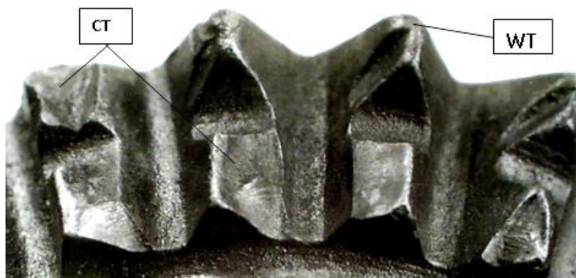
Рисунок 2.4 – Скол (СТ) зубьев на шарошке долота типа Т. Несколотые зубья изношены со скруглением (WT)
