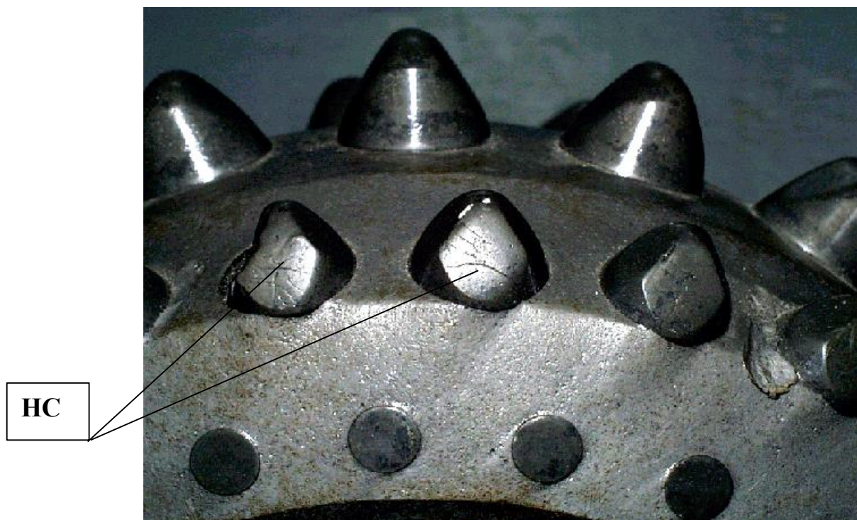
Рисунок 2.10 – Температурные трещины на периферийных зубках долота типа MC3
