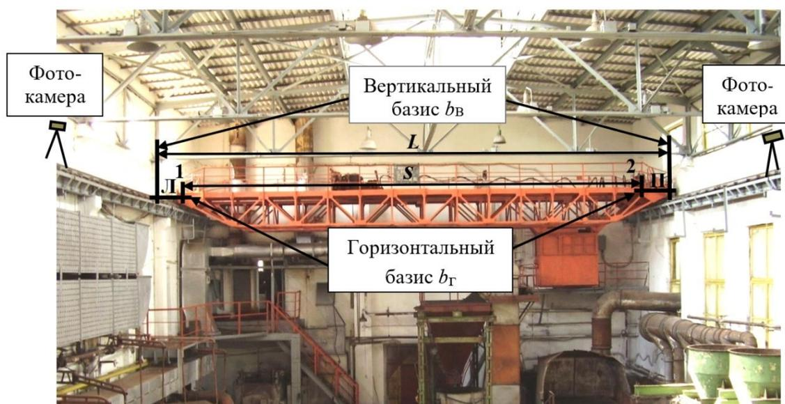
Рис.40. Мостовой кран с марками 1, 2 и горизонтальными и вертикальными базисами
