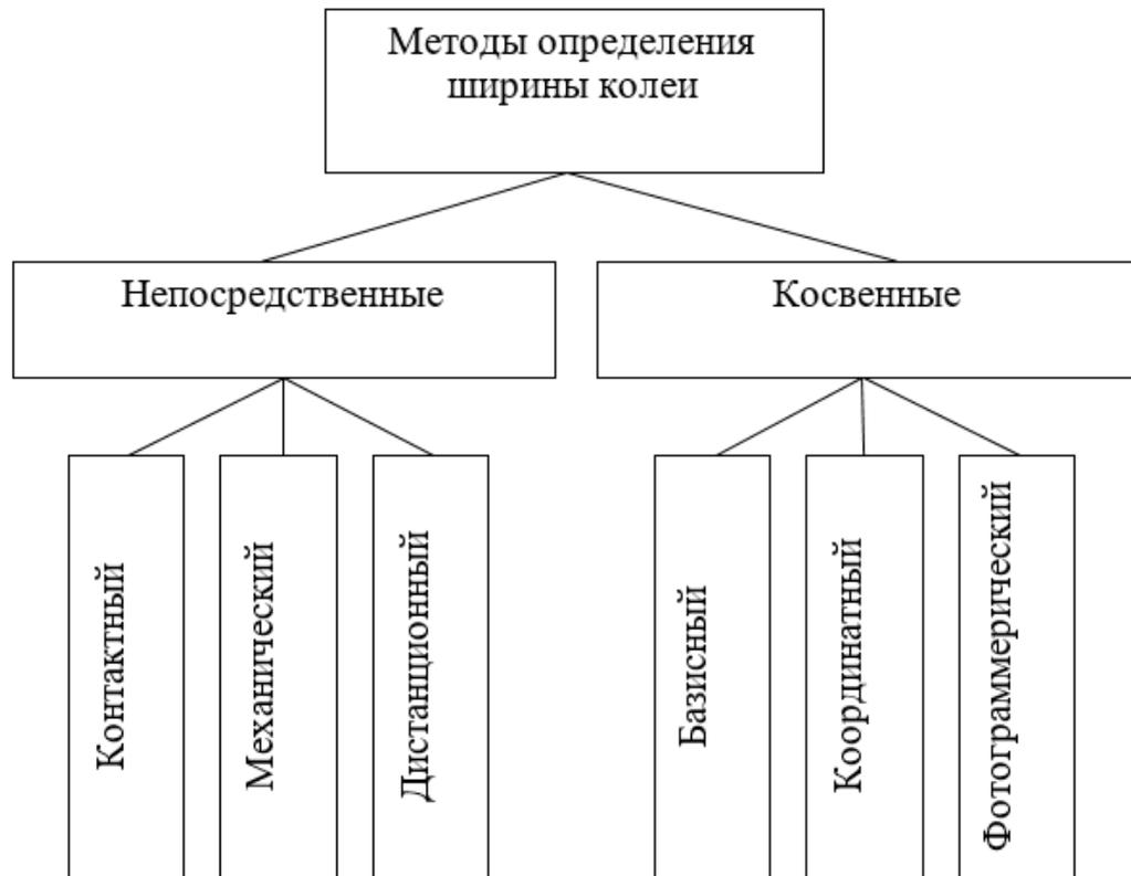
Рис.37. Классификация методов определения ширины колеи
