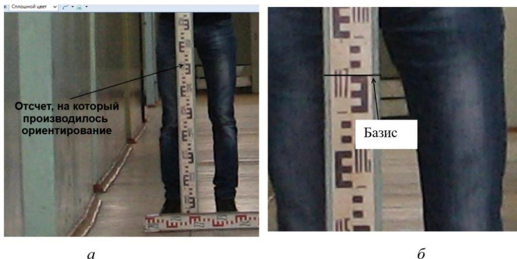
Рис.25. К обработке снимка в *Paint.NET* на этапе фиксации базиса.
