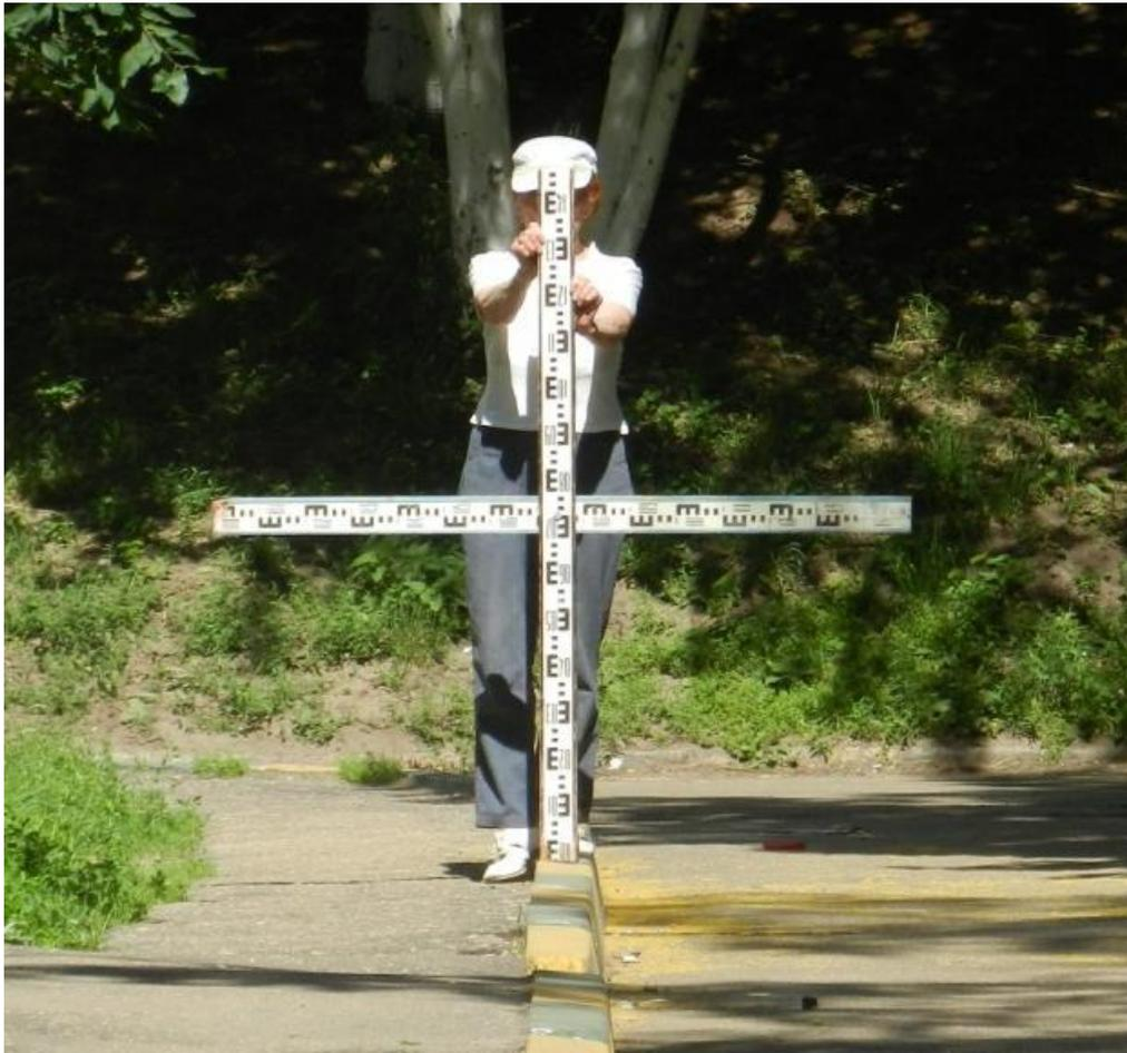
Рис.15. Горизонтальный и вертикальный базисы
