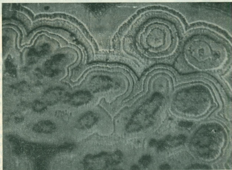
Рис. 5. Коллоидная и почковидная текстуры коллоидных агрегатов пиролизита (белое) и лампадита (серое). Месторождение Каджаран, Армянская ССР. Полированный шлиф. Ув. 100
