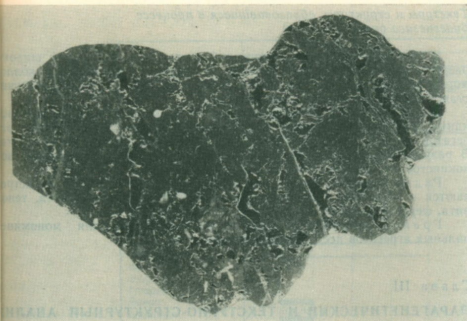
Рис. 11. Кавернозная текстура. Гётит и ярозит (темно-серое) с тонкими прожилками и вкрапленностью самородной меди (белое), с пустотками выщелачивания (черное). Месторождение Каджаран, карьер. Образец. Натуральная величина
