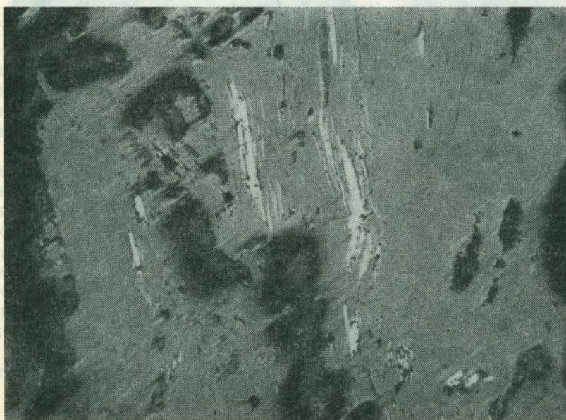
Рис. 21. Реликты молибденита (белое) и кварца (темно-серое) в повеллите (серое). Месторождение Каджаран, Армянская ССР. Полированный шлиф. Ув. 80
