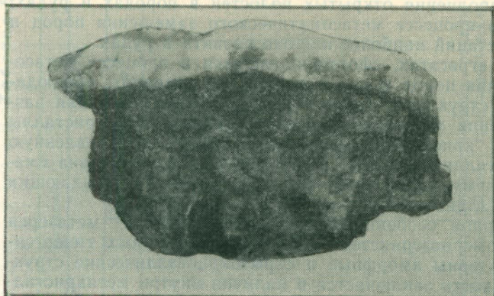
Рис. 3. Корковая текстура. Корочка арагонита (белое) развита на трещине в лимонитизированной породе (темно-серое). Место рождение Каджаран карьер. Натуральная величина
