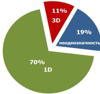
Рисунок 4 – Диаграмма для оценки «размерности» кривых ЗСБ на основе выборки из 80000 физических наблюдений (юг Сибирской платформы)
