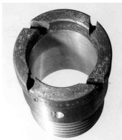
Рис. 2.6. Алмазная коронка с винтообразными промывочными каналами
