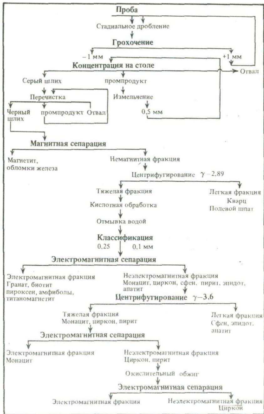
Рис. 1. Схема сепарации акцессорных минералов из среднезернистых пород
