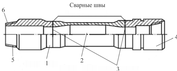
Рис. 18. Виды аварий с бурильными трубами: 1 – износ по телу трубы; 2 – слом по телу трубы, разрыв тела трубы; 3 – слом по сварному шву; 4 – разрушение по телу муфт и замков; 5 – слом в утолщенном конце резьбы (третья–пятая нитки); 6 – износ резьбового соединения, промыв витков резьбового соединения
