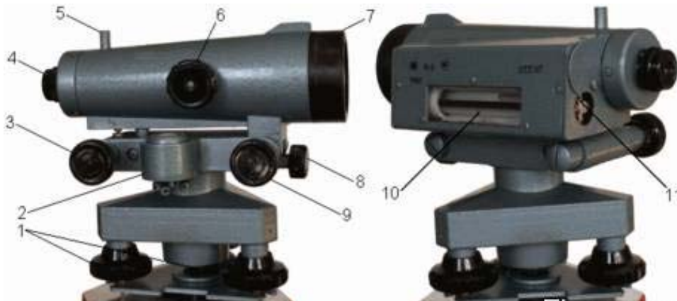
Рисунок 76. Устройство нивелира Н – 3
