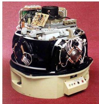
Рис. 1.15. Аэроморской гравиметр нового поколения Чекан-АР
