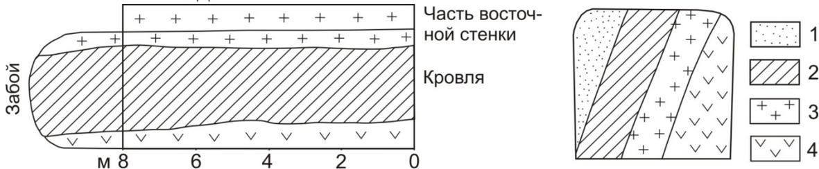
Рис. 3. Пример частичной развертки при документации горизонтальной горной выработки. Условные обозначения см. на рис. 3
