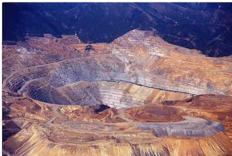
Рис. 9.6. Карьер Кенекотт на эоценовом меднопорфировом месторождении Бингем, 60 км к ЮВ от г. Солт Лейк Сити, штат Юта, считается крупнейшей открытой выработкой на Земле – 4,5 км в диаметре при глубине 1,3 км www.flickr.com/photos/404873991/
