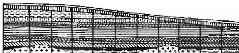
Рис. 9.28. Геологический разрез одного из участков Никопольского место- рождения марганца. По Д.И. Покровскому. 1-5 – четвертичные отложения (1 – чернозем, лесс, 3 – глина красная, 4 глина бурая, 5 – песок); 6- 7 – плиоценовые отложения (6 – глина серо-зеленая, 7 – известняк); 8-10 – миоценовые отложения (8 – глина серо-белая, 9 – глина черная, 10 – песок зеленый); 11-13 – олигоценовые отложения (11 – глина зеленая, 12 – марганцевая руда, 13 – каолин); 14 – докембрий.
