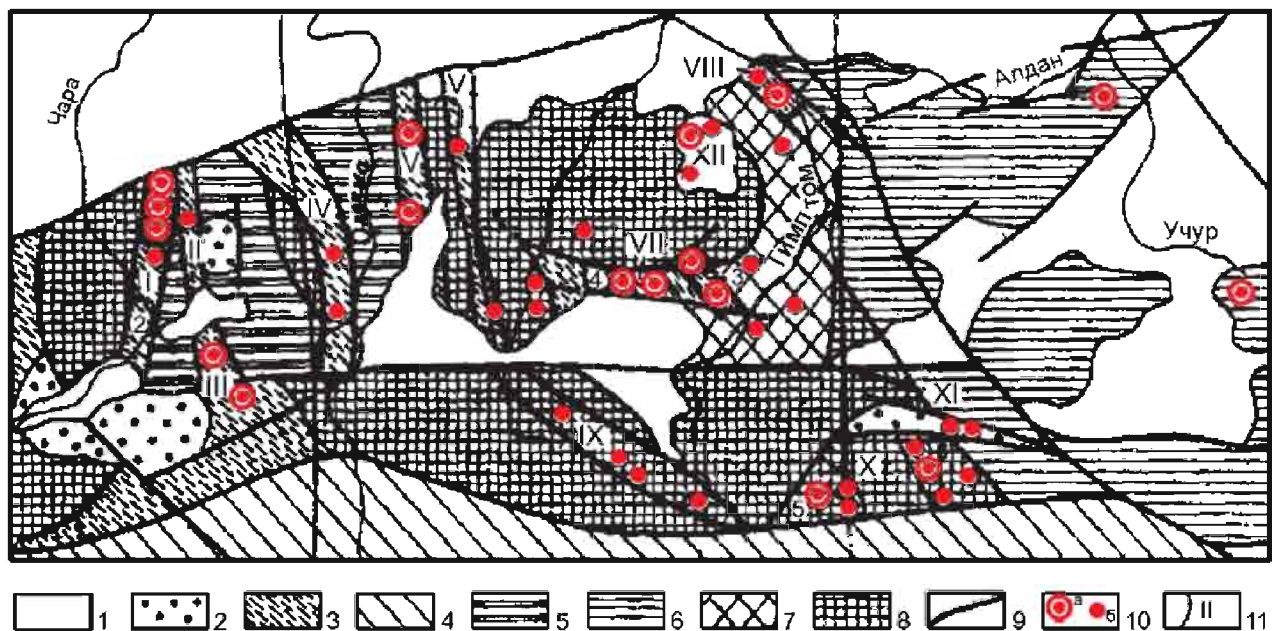
Рис. 1.8. Районирование Алданской железорудной провинции, Якутия. Из (Геология СССР, Якутская...). 1 – верхнепротерозойско-кайнозойские отложения платформенного чехла; 2 – нижнепротерозойские орогенные отложения в прогибах и впадинах; 3–8 – архейские метаморфические образования кристаллического фундамента Алданского щита: 3 – борсалинская, 4 – становая, 5 – олекминская, 6 – джелтулинская, 7 – тимптонская, 8 – иенгрская серии; 9 – разломы; 10 – железорудные месторождения (а) и проявления (б); 11 – границы железорудных зон, районов и их номера. Районирование: Чаро-Олекминская субпровинция: железорудные зоны: I – Чаро-Токкинская с Ималыкским (1) и Суломатским (2) районами, II – Токкинская, III – Ханинская, IV – Тас-Миелинская, V – Олекмо-Амгинская, VI – Верхне-Амгинская; Алдано-Тимптонская субпровинция: железорудные зоны: VII – Дес-Леглиерская с Леглиерским (3) и Дес-Сиванглинским (4) районами, VIII – Эмельджакский район, IX – Холодниковский район, X – Сутамо-Гонамская с Гонамским (5) и Сутамским (6) районами, XI – Нуямский район, XII – Центрально-Алданский район.
