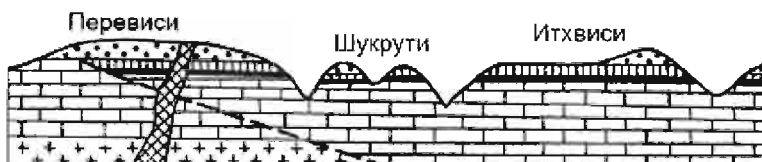
Рис. 9.29. Положение рудноносного горизонта в геологическом разрезе марганцевого месторождения Чиатури, Грузия. По А.Г. Бетехтину. 1 – кварцевые
