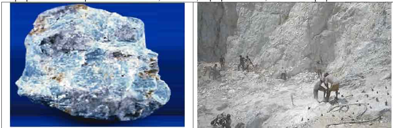
Рис. 3.11. Слева – жильные кианит и силлиманит из образований серии Саколи, рудник Паври Кианит в округе Бхандара, штат Махараштра, Центральная Индия. Справа – карьерные разработки высокоглиноземистых пород на том руднике. Подготовка очередного блока к отпалке http://www.pavrikyanite.com/mining.JPG
