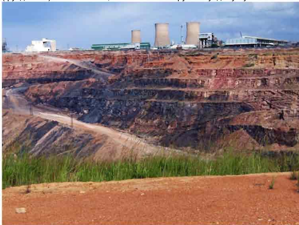
Рис. 3.17. Открытые разработки медных руд в рудном районе Сингола, Замбия, сопровождаются предприятиями по метал-лургическому переделу меди (Undergroud development...2007).
