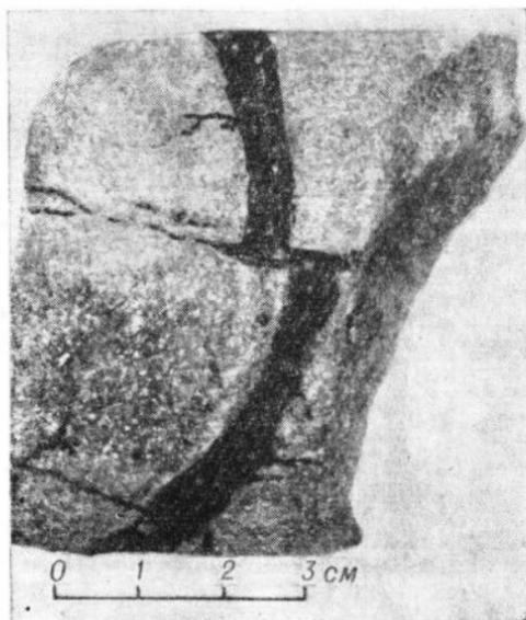
Рис. 42. Прожилковая магнетитовая руда. Прожилки магнетита развиты по двум пересекающимся системам трещин. Куржункуль, скв. 44, гл. 163 м Штуф.
