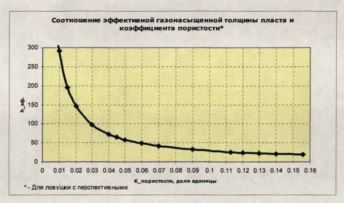
Рисунок 6.2.1 – Соотношение эффективной газонасыщенной толщины пласта и коэффициента пористости
