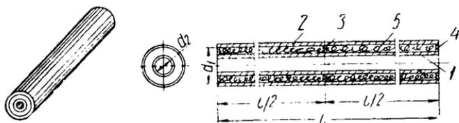
Рис. 47. Одноканальная асбестоцементная теплоизоляционная оболочка
