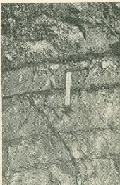
Рис. 3. Мерзлые суглинки со льдом в трещинах (сетчатая криогенная текстура).
