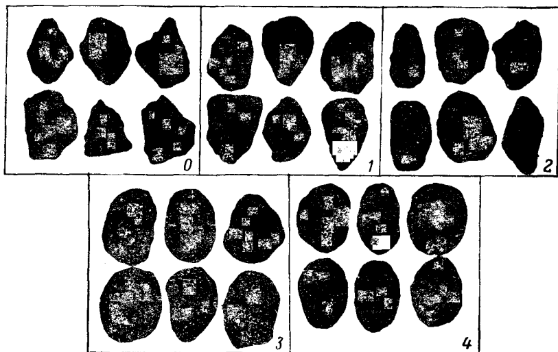
ФИГ. 1-4. ШКАЛА ДЛЯ ОПРЕДЕЛЕНИЯ ОКАТАННОСТИ ОБЛОМКОВ. 0, 1, 2, 3, 4 — баллы окатанности [Рухин, 1961].
