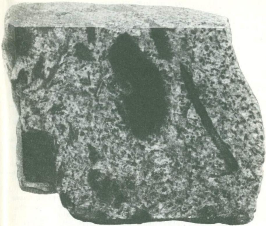
Фиг. 40. Ксенолиты ортороговика в среднезернистом нефелиновом сиените. Приполированная поверхность образца. Натур. вел.
