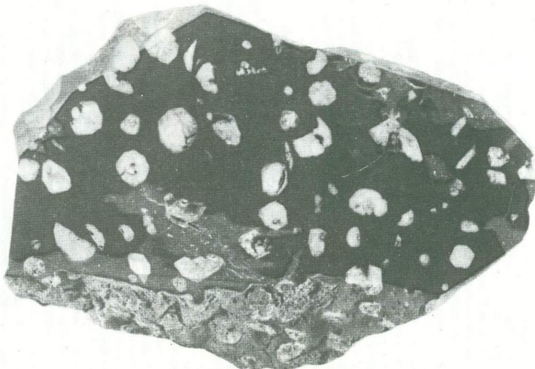
Фиг. 5. Эпилейцитовый порфир. Приполированная поверхность образца. Видны форма и размеры целых тетрагон-триоктаэдрических фенокристаллов эпилейзита и их обломков. Натур. вел.
