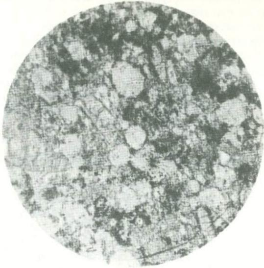
Фиг. 3. Эпилейцитовый порфирит. Общий вид микроструктуры. Многочисленные фенокристаллы эпилейциита и авгита в сильно метаморфизованной основной массе. Обр. 195, между п. XII и IX. Без анализатора, увел. 15
