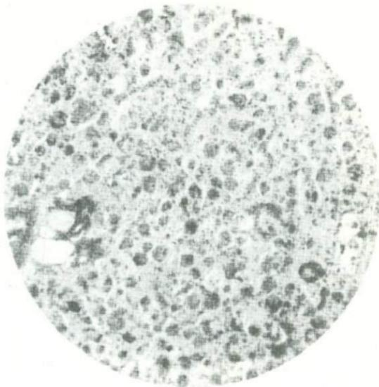
Фиг. 11. Эпилейцитовый порфир. Оцелляровая структура основной массы. В преобладающих в основной массе мелких кристаллах эпилейциита концентрируются субмикроскопические частицы зеленой слюды, благодаря чему они выделяются из окружающей массы. Обр. 326, юго-западный склон горы Коркуталь. Без анализатора, увел. 15
