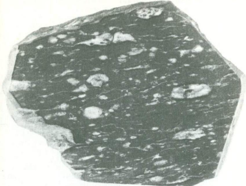
Фиг. 6. Рассланцованный метаморфизованный эпилейцитовый порфир. Приполированная поверхность образца. Видны линзовидные очертания деформированных фенокристаллов эпилейцита. Натур. вел.
