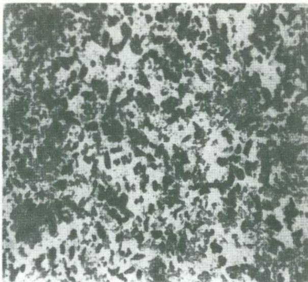
Фиг. 43. Меланократовый роговообманковый ортороговик. Равномернозернистая грано-блестовая структура. Бесцветные минералы – полевой шпат и нефелин. Обр. 239, "Каменный бугор" (п. VI). Без анализатора, увел. 20
