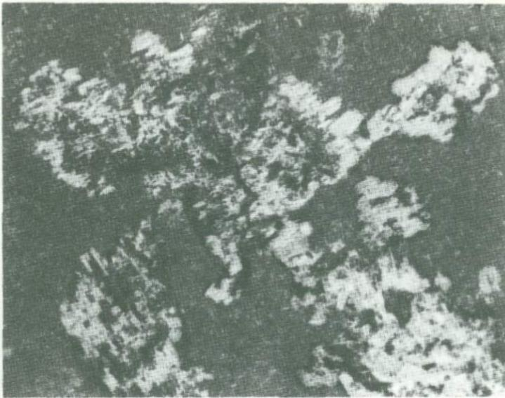
Фиг. 38. Порфиробласти скаполита в ортороговике первого типа. Скаполит переполнен пойкилитовыми включениями полевого шпата и биотита. Порфиробласти имеют "ситовидные" или "лапчатые" очертания. Обр. 294, северный склон "Каменного бугра" (п. VI). Николи скрещены, увел. 25
