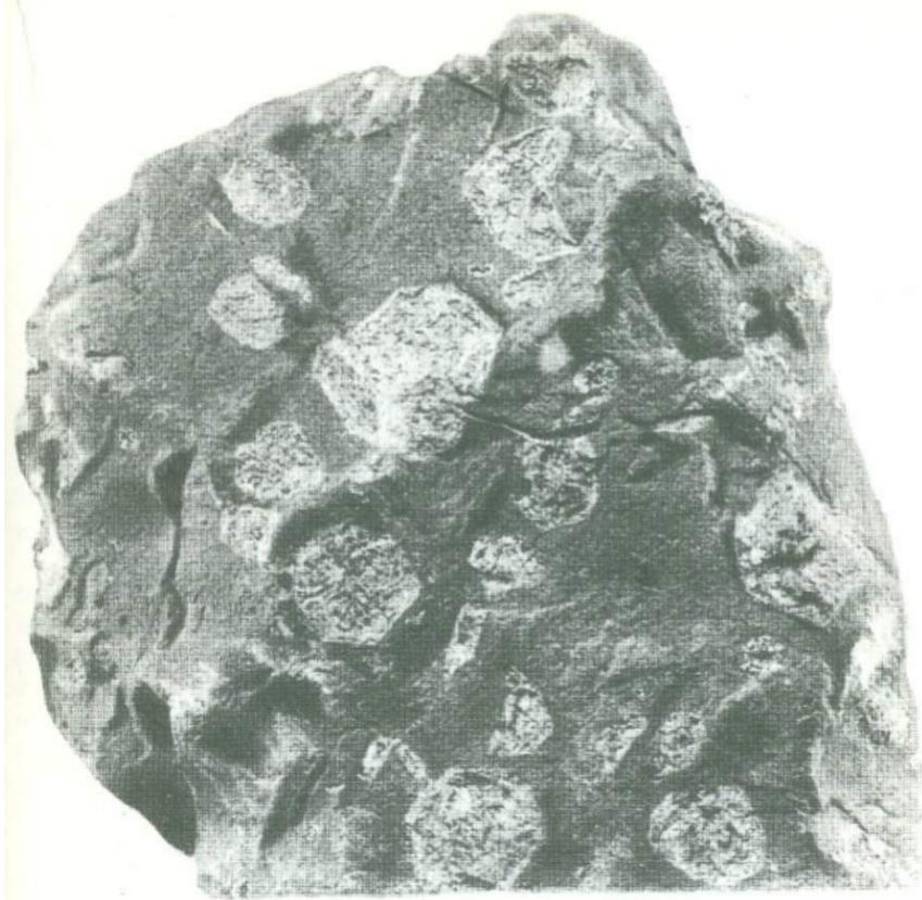
Фиг. 7. Псевдолейцитовый порфир. Ровная выветрелая поверхность образца. Видно внутреннее строение псевдоморф по лейшиту, так как на месте зерен нефелина при выветривании образуются углубления. Натур. вел.
