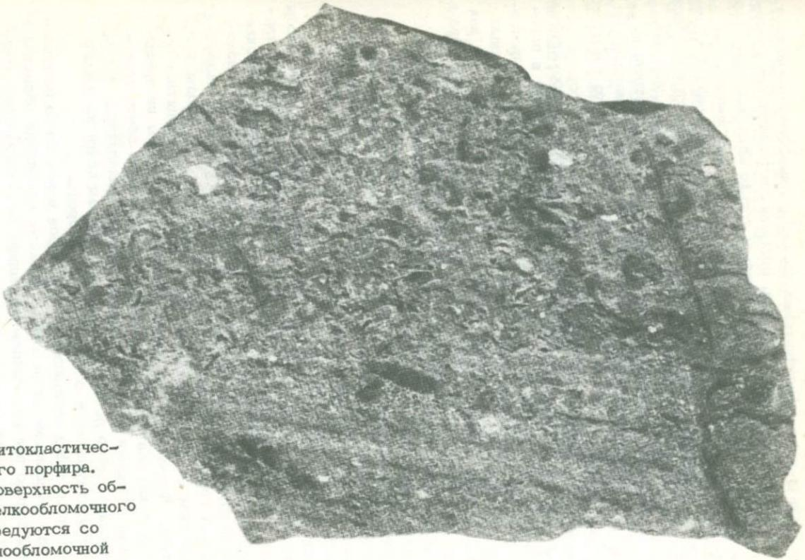
Фиг. 12. Слоистый, литокластический туф эпилейшитового порфира. Ровная выветрелая поверхность образца. Слои более мелкообломочного сложения (внизу) чередуются со слоями с более крупнообломочной структурой (вверху). В последних видны и размеры обломков. Видны отдельные обломки фенокристаллов эпилейшита. 3/4 натур. вел.
