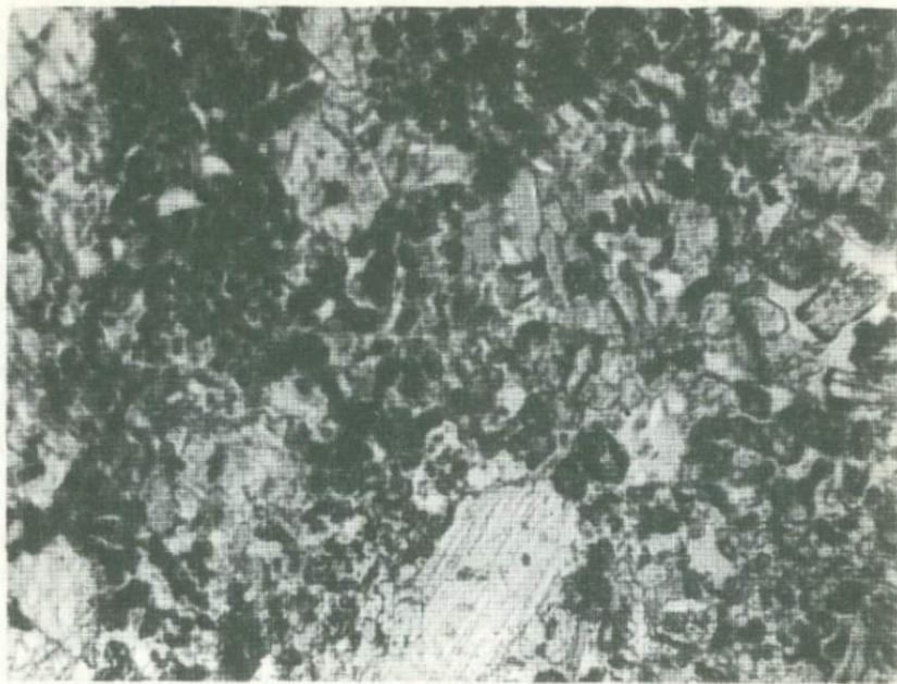
Фиг. 46. Меланократовый оливинсодержащий "метапорфиит". Небольшие фенокристаллы авгита без характерных включений рудного минерала. В основной массе много округлых зерен оливина, расположенного по краям зерен в рудный минерал Обр. 331, между п. X1 и XII. Без анализатора, увел. 25
