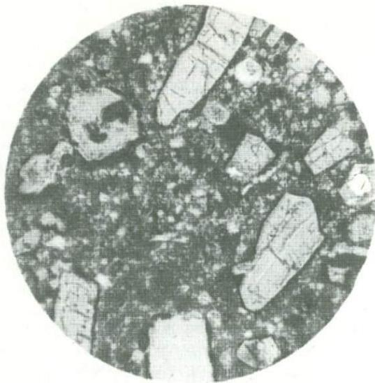
Фиг. 4. Эпилейцитовый порфирит. Общий вид микроструктуры. Многочисленные мелкие фенокристаллы зонального авгита и псевдоморфозы по кристаллам лейшита. В основной массе заметны следы оцелляровой структуры. Обр. 223, около п.И. Без анализатора, увел. 20
