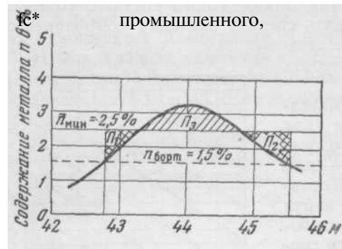
Рис. 138. Пример определения бортового содержания (по В. В. Померанцеву)
