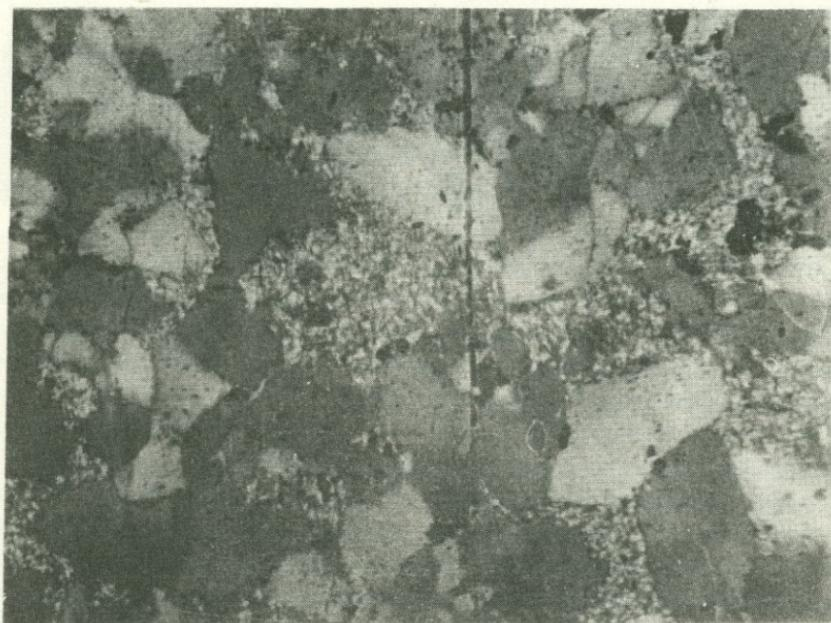
Рис. 7. Небольшие скопления серицита между зернами кварца (монокварцевая фация). Ник.+<sup>x</sup>, увеличение 75<sup>х</sup>.
