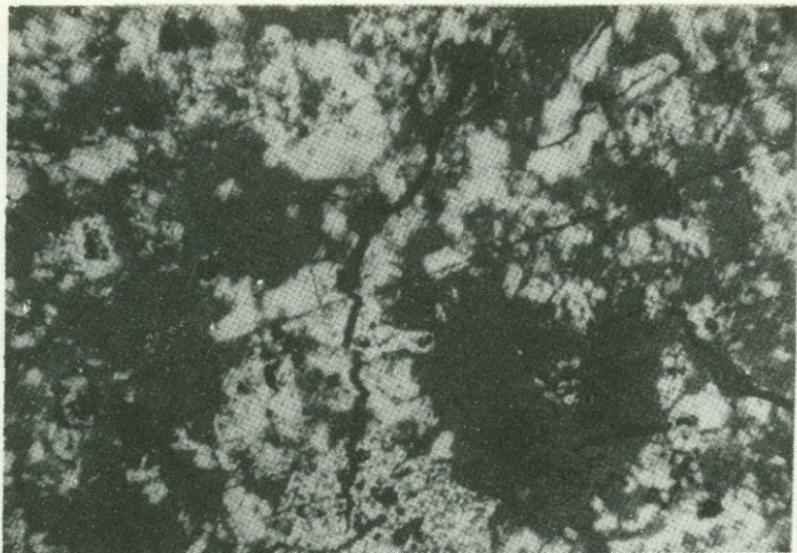
Рис. 22 Плохо ракристаллизованные массы микрокристаллических агрегатов  $\text{MoS}_2$  (белое) с заметными внутри них остатками исходной смеси (черные точки). Полир. шлиф - брикет. Ув. 550 х.
