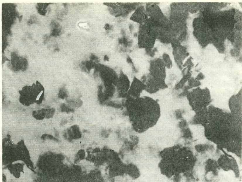
Рис. 31 Микроморфология кристаллов монтмориллонитизированного серицита (края пластинок серицитов размыты). Суспензия. Увеличение 10000<sup>х</sup>.
