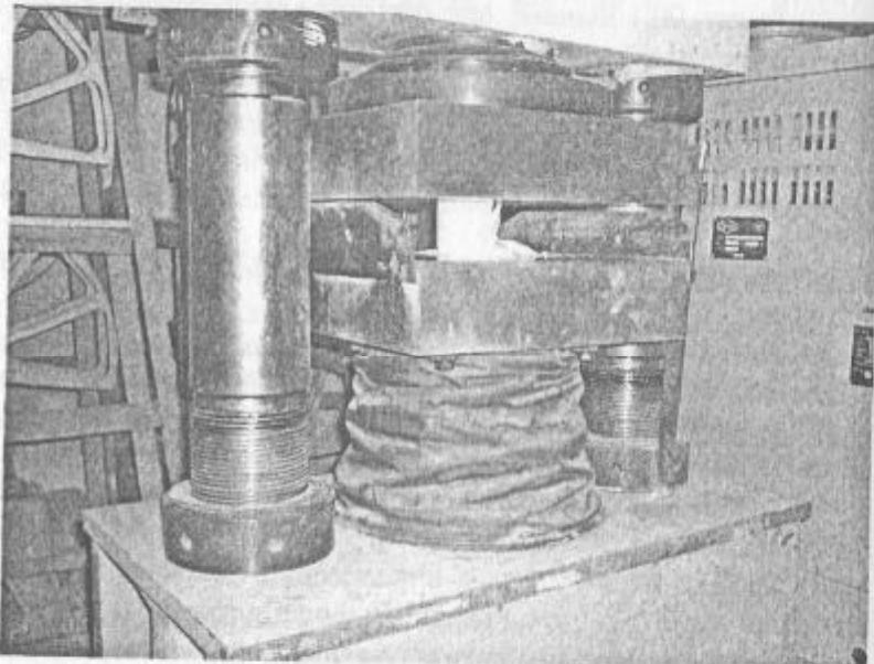
Рис. 6.1. Испытания пород на предел прочности при одноосном сжатии:
