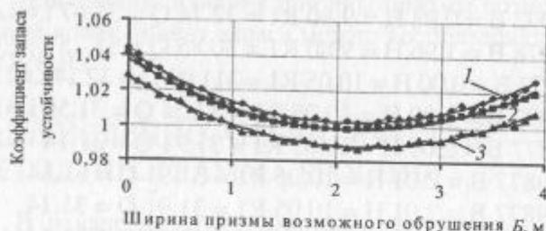
Рис. 11.6. Зависимость коэффициента запаса устойчивости от ширины призмы возможного обрушения при различной высоте откоса:
