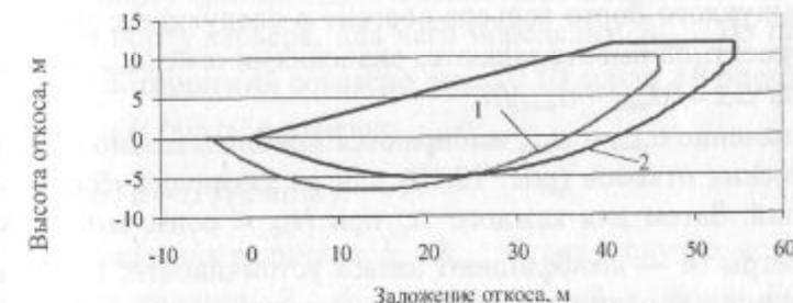
Рис. 10.9. Сравнение параметров предельного откоса, полученных по результатам построений в excel для программ SPB133 и PREDH:
