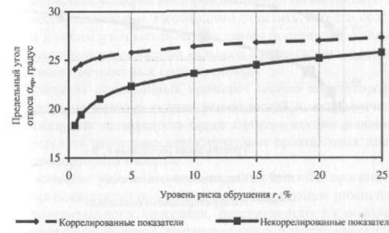
Рис. 15.7. Графики зависимостей угла предельного откоса  $\alpha_{np}$  от уровня риска обрушения при  $H = 50$  м
