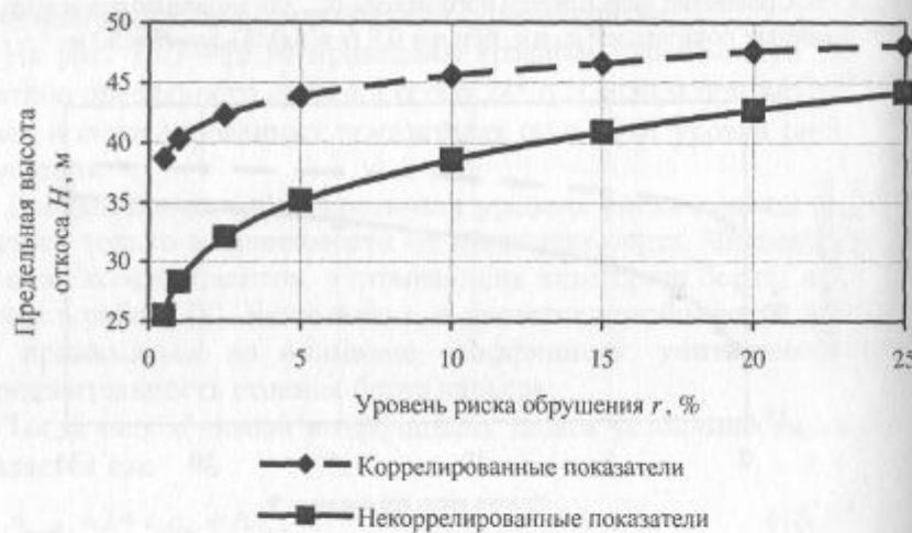
Рис. 15.9. Графики зависимостей предельной высоты откоса от уровня риска обрушения при  $\alpha = 28^\circ$
