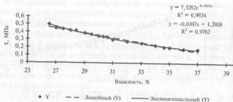
Рис. 5.8. Зависимость сопротивления пород сдвигу от влажности при  $\sigma = 0,4$  МПа
