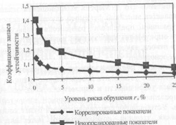
Рис. 15.10. Графики зависимостей коэффициента запаса устойчивости от уровня риска обрушения при  $\alpha = 28^\circ$
