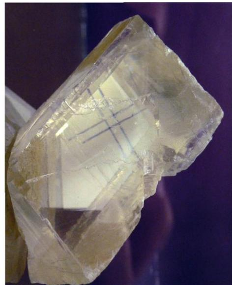
Рис. 12. Двупреломление
