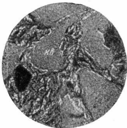
Рис. 5. Гидрослюдистый цемент. Зерна кварца корродированы (кв). Алевролит. Увел. 120, без анализатора
