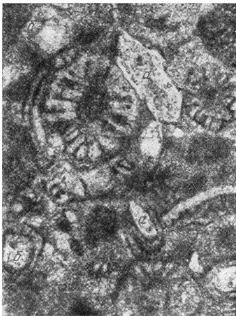
Рис. 7. Регенерация обломочных зерен: а — кварца с появлением идиоморфных ограничений, б — полевых шпатов в форме оторочек обрастания. Известняк оолитовый, перекристаллизованный. Чувьский ярус. Увел. 224, без анализатора
