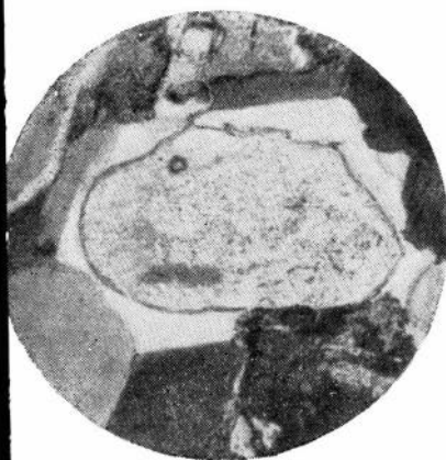
Рис. 8. Регенерация плагиоклаза. Песчаник. Увел. 120, с анализатором
