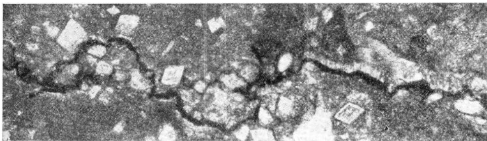
Рис. 2. Микростилолитовое растворение и скопление ромбоздров доломита вокруг микростилолитового шва. Известняк доломитовый. Криволуцкий ярус. Увел. 187, без анализатора
