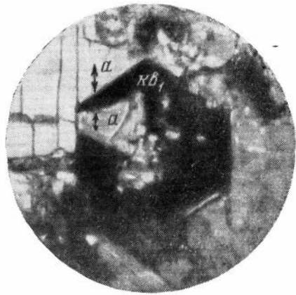
Рис. 10. Кристалл кварца (кв) с включением ангидрита (а). Мергель. Увел. 300, с анализатором
