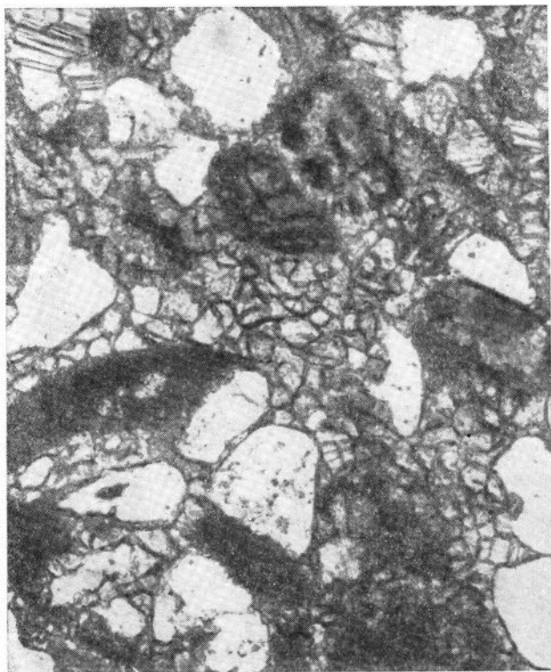
Рис. 4. Разъедание и замещение обломочных зерен кварца кальцитом. Известняк песчаный. Мангазейский ярус. Увел. 110, без анализатора
