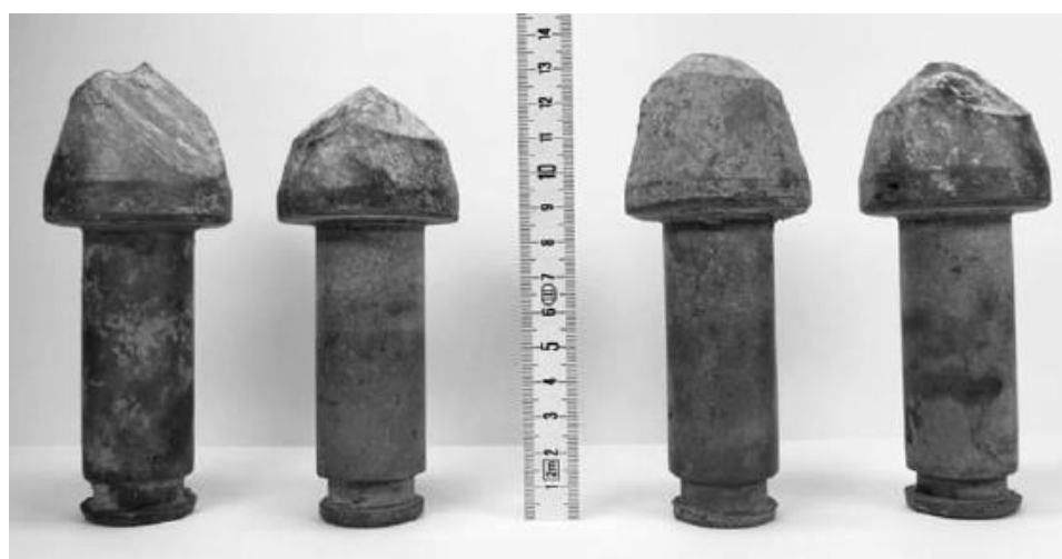
Рисунок 2.15 – Общий вид резцов РШ33-85/17,5 с образовавшейся плоскостью износа после поломки твердосплавной вставки
