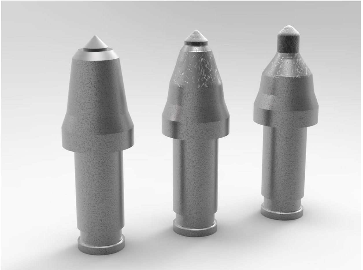
Рисунок 2.27 – Модели поворотного резца РШ 32-70/16.M1 при разрушении алевролита на пройденном пути L_{\text{расч}} = 0 км, L_{\text{расч}} = 5 км, L_{\text{расч}} = 13,5 км.
