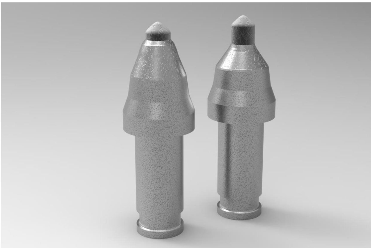
Рисунок 5.10 – Формы износа резца РШ 32-70/16.М1, изготовленного по усовершенствованной технологии (а), по сравнению с резцом, изготовленным по существующей технологии (б), при одинаковом пути резания при разрушении алевролита ( L=13,5 км)
