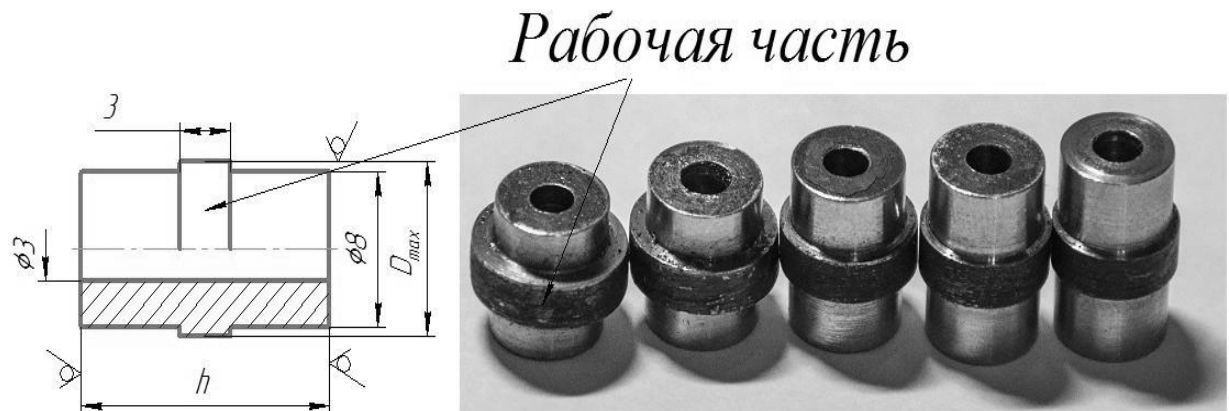
Рисунок 3.5 - Вид фрагментов с рабочей частью, подвергнутой деформации с различной интенсивностью, для испытаний на износостойкость
