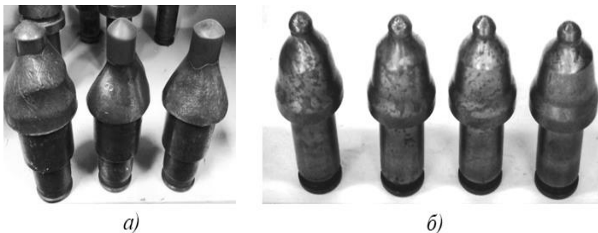
Рисунок 2.9 – Вид поворотных резцов после эксплуатации: а) зарубежный производитель ( Alpine ); б) отечественный производитель (ОАО «Горный инструмент» резец РШ 32-70/16SK).
