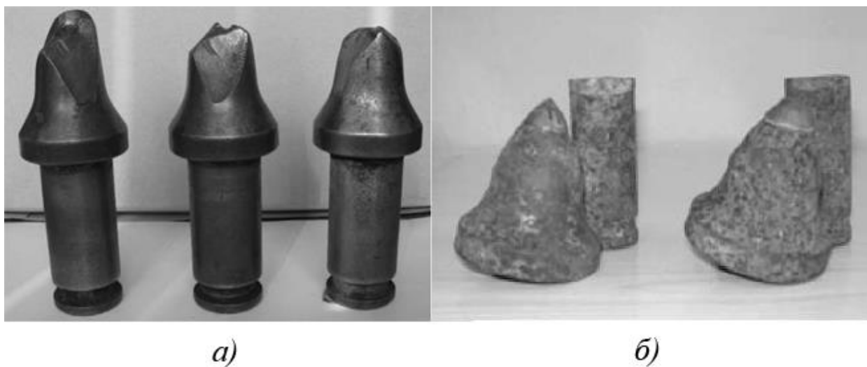
Рисунок 2.13 – Общий вид поворотных резцов после действия пиковых нагрузок: а ) поломка твердосплавной вставки (совместно со сколом в головной части державки); б ) поломка хвостовика в месте сопряжения с головной частью.
