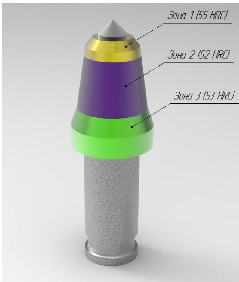
Рисунок 5.9 – Распределение твердости по зонам в местах повышенного износа
