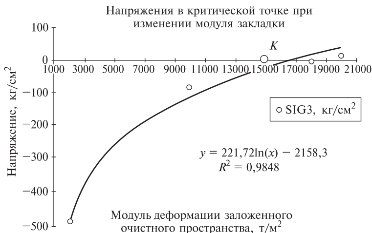
Рис. 13.5. График зависимости экстремальных напряжений в плите (точка B ) от модуля деформации зоны очистных работ после закладки (все данные по упругим решениям, за исключением точки K , полученной по результатам решения упругопластической задачи
