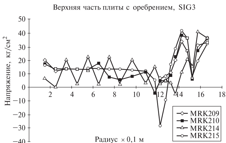
Рис. 14.5. Распределение минимальных напряжений по радиусу плиты
