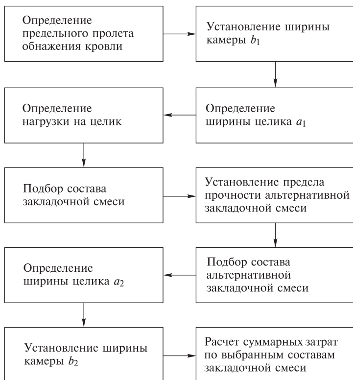
Рис. 5.1. Алгоритм определения оптимальных размеров искусственных целиков
