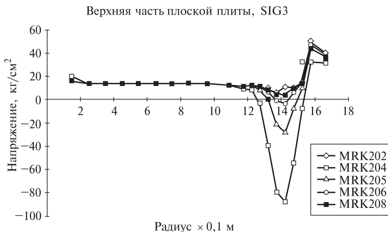
Рис. 14.2. Распределение наибольших напряжений растяжения по радиусу плиты
