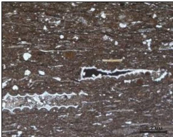
Рисунок 3.11. Тип пород II.B.1 – Образец 49-ТТ, скважина Тлянчи-Тамакская. Ритмит известковый углеродистый. Фотография шлифа (николи X)
