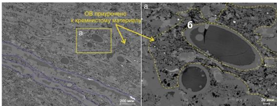
Рисунок 4.19. Чередование кремнистых прослоев, насыщенных ОВ и карбонатных прослоев. Снимки РЭМ образца 18-Б, скважина Березовская
