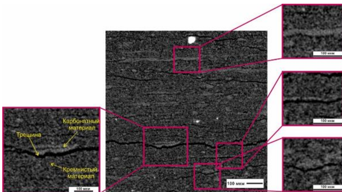
Рисунок 4.21. Образование трещин по границе соприкосновения двух минеральных фаз. Образец 4-Б, скважина Березовская
