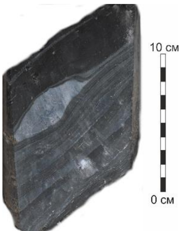
Рисунок 3.34. Фотография образца скважины Азнакаевская: керогенонасыщенные слоистые породы, светло-серая карбонатная конкреция
