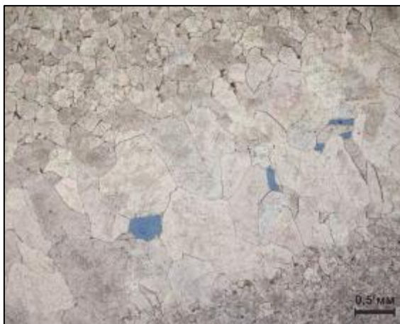
Рисунок 3.4. Тип пород I.A.1 – Образец 23-Аз, скважина Азнакаевская. Доломит. Фотография шлифа (николи II)
