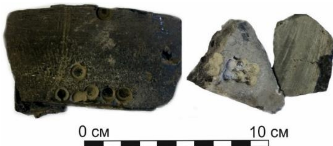
Рисунок 3.1. Фотографии примера отбора экспериментальных цилиндрических образцов
