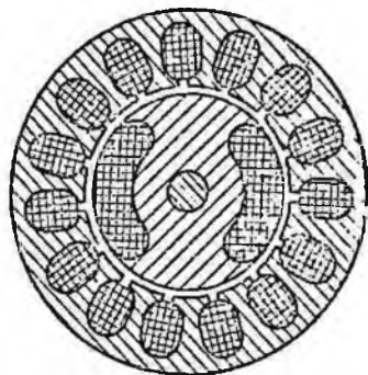
Рис. 21. Устройство сельсина с однолучевой роторной и трехлучевой статорной обмотками.
