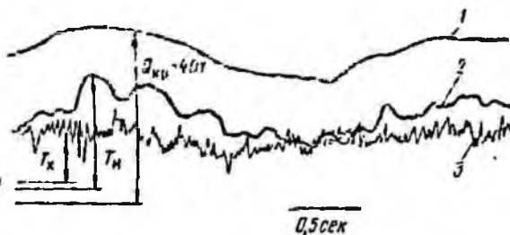
Рис. 6. Осциллограмма натяжений неподвижного и ходового концов талевого каната и нагрузки на крюке при спуске 100 свечей на буровой № 280 НПУ «Песчаныйнефть», сопровождающийся прихватами инструмента (диаметр каната 28 мм; оснастка 5×6; длина неподвижного конца каната 41 м):
