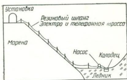
Рис. 2. Схема водозабора на леднике Гарабаши.
