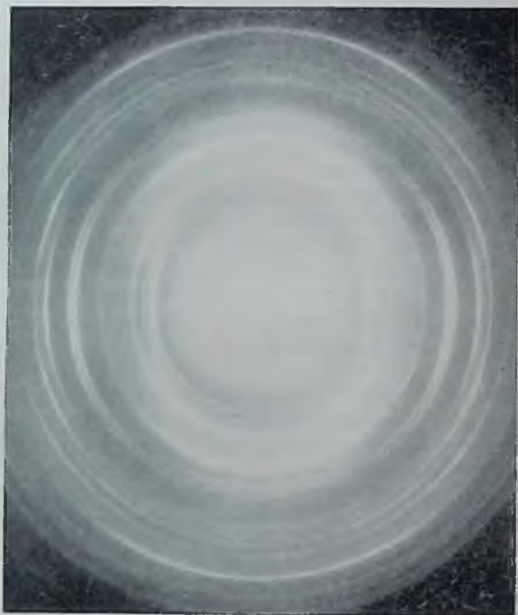
Фиг. 1. Электронограмма косої текстуры молибденита 2H
