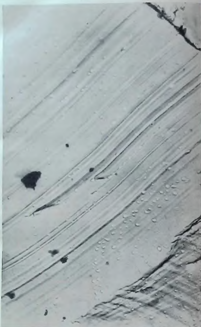
Фиг. 5. Сверхтонкие линейные скульптуры на грани (111) плоского кристалла золота. Балейское месторождение. Целлюлозно-угольная реплика. Увел. 4000
