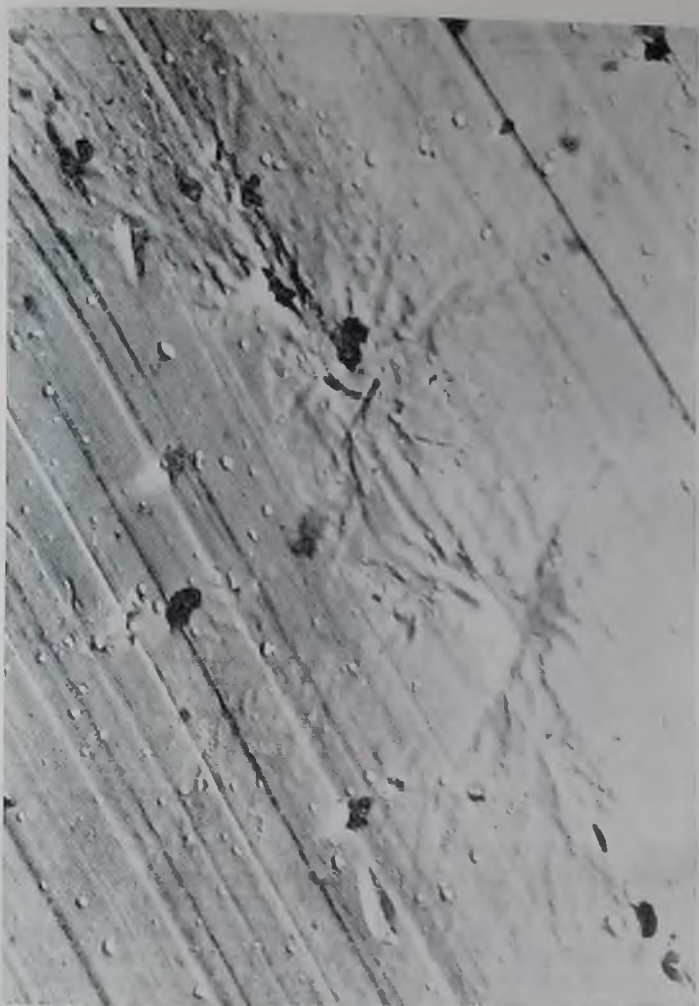
Фиг. 8. Дендритовые микроскульптуры на грани (111) плоского кристалла золота. Балейское месторождение. Целлюлозно-угольная реплика, Увел. 4000
