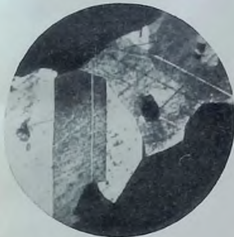
Фиг. 9. Тип двойников золота. Фото шлифа, протравленного \text{CrO}_3 + \text{HCl} (темное — кварц). Увел. 300
