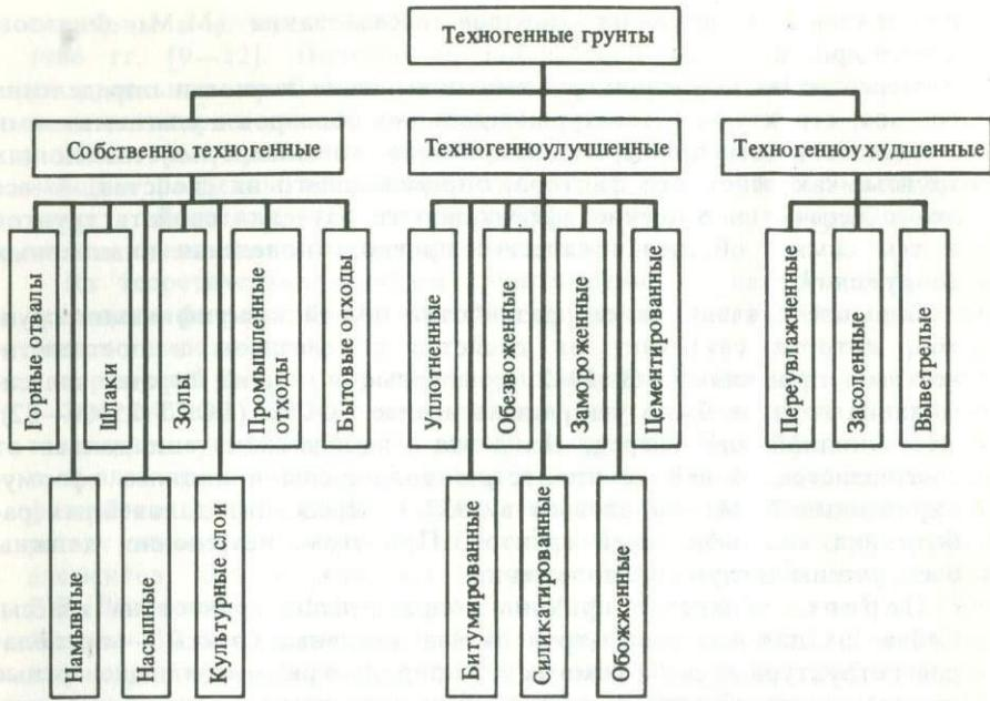
Рис. 3. Схематическое подразделение техногенных грунтов
