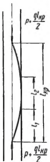
Рис. 10. Форма искривления низа колонны с опертыми концами.
