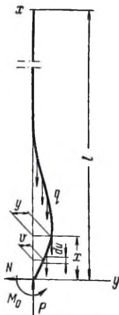
Рис. 6. Искривление колонны с заделанными концами.
