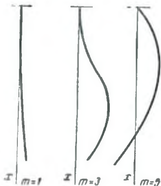
Рис. 15. Формы искривления буровой колонны.
