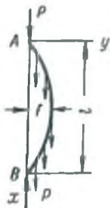
Рис. 3. Искривление стержня под действием собственного веса и концевой силы.
