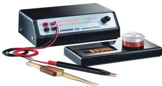
Рис. 90. Гальванический аппарат для локального родирования [40]
