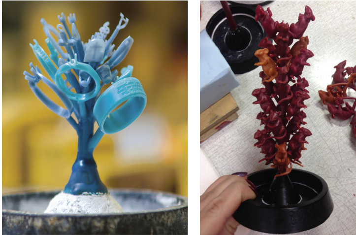
Рис. 79. Модельный блок — «елочка» — в сборе (фото из архива кафедры ТХОМ УрФУ)
