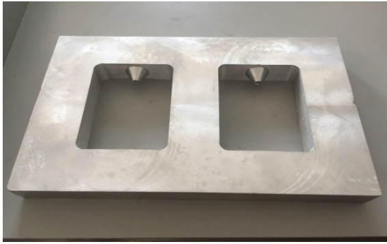
Рис. 74. Алюминиевые рамки для получения эластичных пресс-форм [40]
