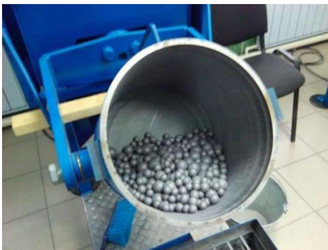
Рисунок 1 - Лабораторная мельница для теста на определение индекса шарового измельчения Бонда
