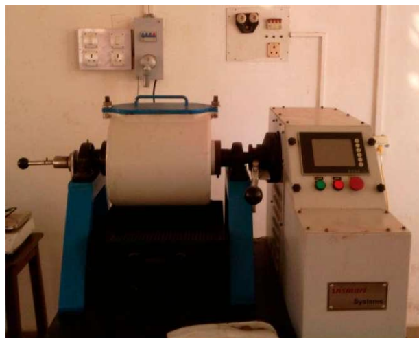
Рисунок 1 - Лабораторная мельница для теста на определение индекса шарового измельчения Бонда
