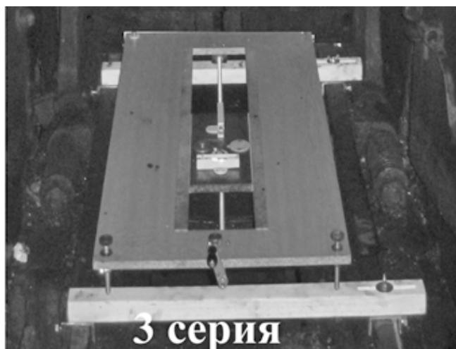
Рисунок 6.9 — Расположение направляющего устройства в устье ствола
