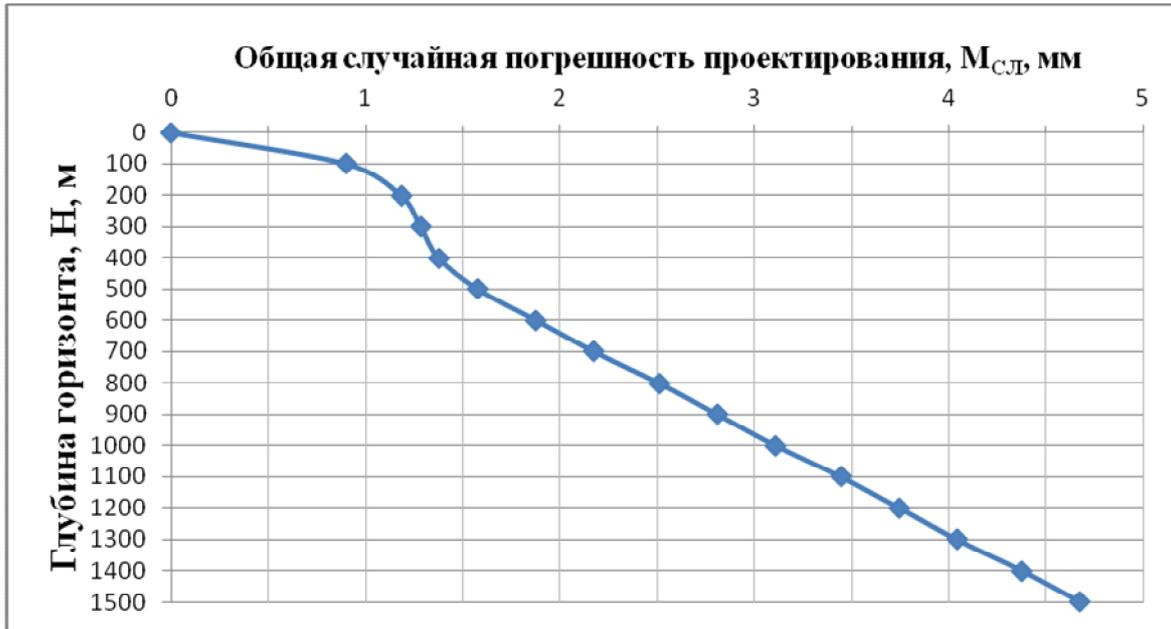
Рисунок 3.18 — График зависимости общей случайной погрешности проектирования от глубины горизонта
