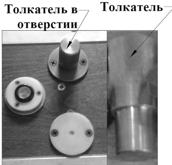
Рисунок 5.9 –Толкатель для двучилиндрического отверстия
