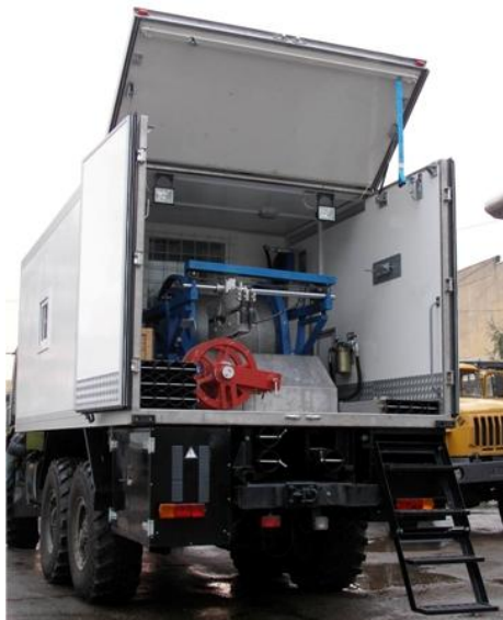
Рис. 15.2. Каротажный подъемник: a – общий вид; б – каротажное отделение; в – секция машиниста
