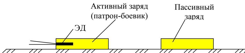
Рис. 4.15. Проба на чувствительность к передаче детонации
