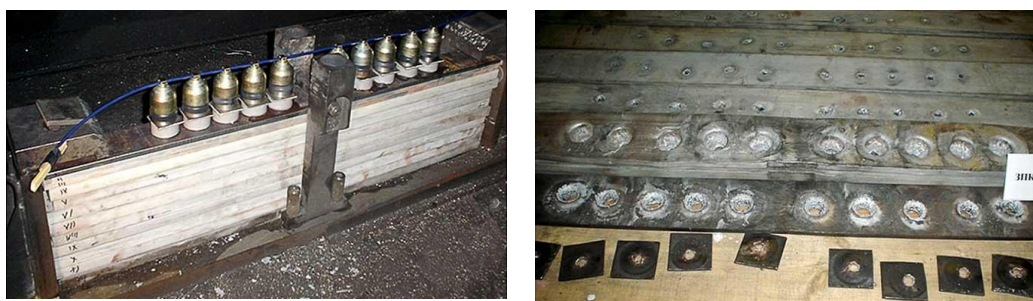
Рис. 17.2. Испытаниекумулятивных зарядов на пробивное действие по пакету стальных пластин
