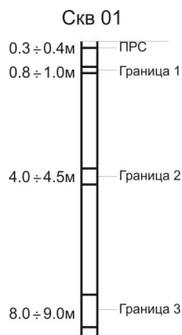
Рис. 1. Скважина 01, построенная по данным метода георадиолокации.
