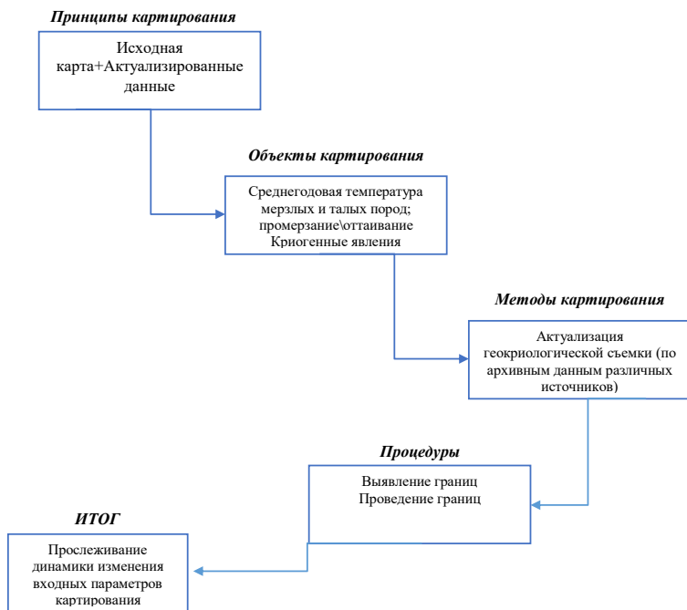
Рисунок 1 – Схематическое планирование методики картирования
