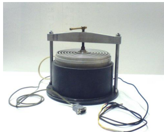
Рис. 3 – Схема устройства для определения коэффициентов теплопроводности грунтов:
