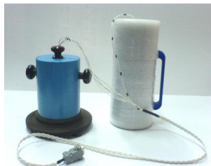
Рис. 4 – Схема и фотография устройства для определения температур начала замерзания растворов и воды в дисперсных материалах:
