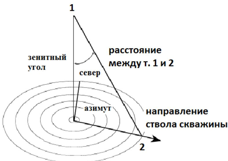
Рисунок 5.1 – Схема измерений параметров искривления ствола скважины
