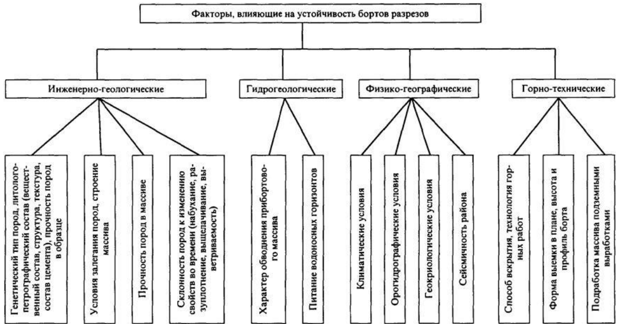
Рисунок 7 - Факторы, влияющие на устойчивость бортов разрезов
