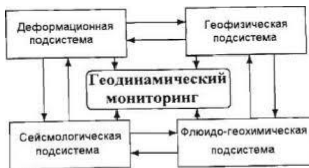
Рисунок 2 - Структура комплексного геодинамического мониторинга природно-техногенных процессов.
