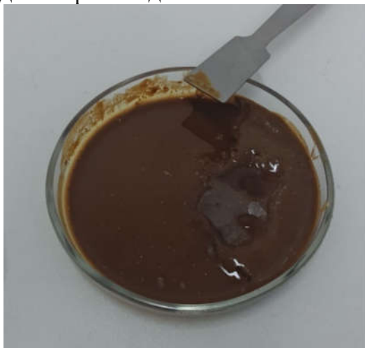
Рисунок 4.3 - Сухая ФФС, отделенная путем испарения избытка воды и формалина.
