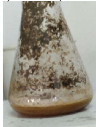
Рисунок 4.2 - Синтез ФФС, выпаривание воды, 20 мин кипячения при 100С
