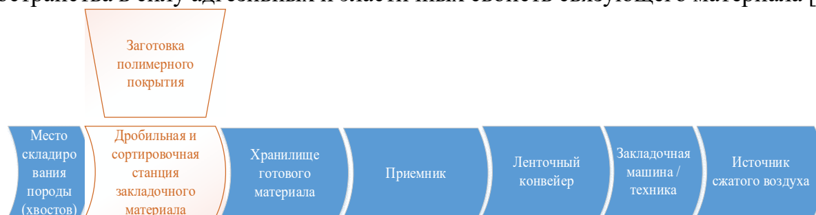
Рисунок 5.7 - Процесс нанесения полимерного покрытия во время закладочных работ
