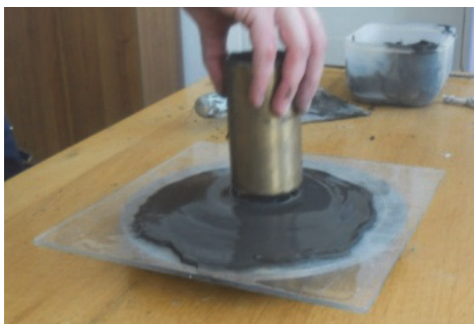
Рис. 2.4. Определение растекаемости закладочной смеси (вискозиметр Сутгарда)
