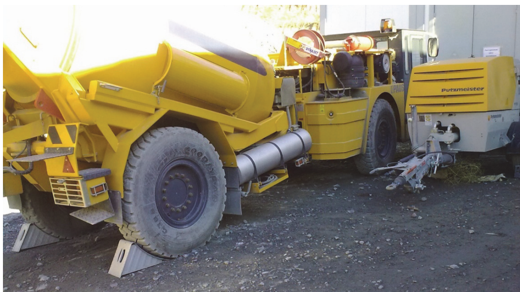
Рис. 1.6. Горно-шахтная машина фирмы PAUS UNI 50-3 миксер
