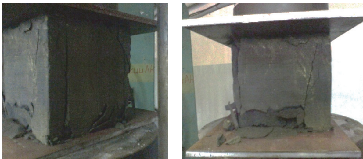
Рис. 2.18. Испытание образцов на прочность составов АХЦ с использованием шаровой мельницы
