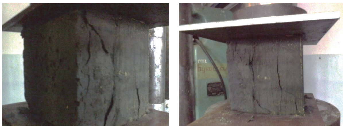
Рис. 2.15. Испытание образцов на прочность составов АХЦ с использованием лопастного смесителя
