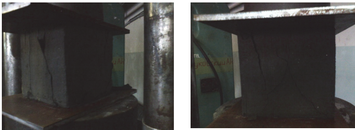
Рис. 3.8. Испытание образцов на прочность составов ХЦ с применением ГКС
