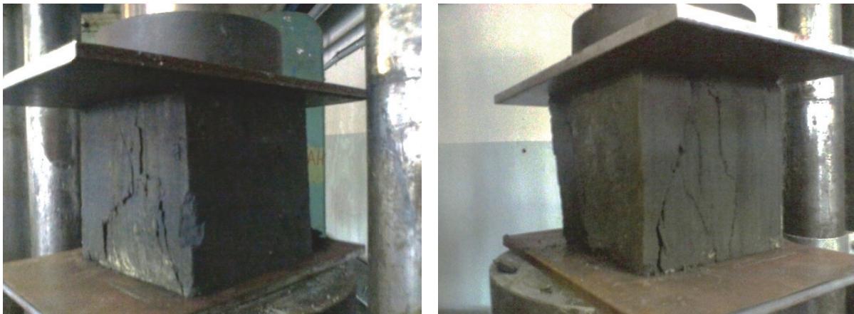
Рис. 2.11. Испытание образцов на прочность составов ХЦ с использованием шаровой мельницы
