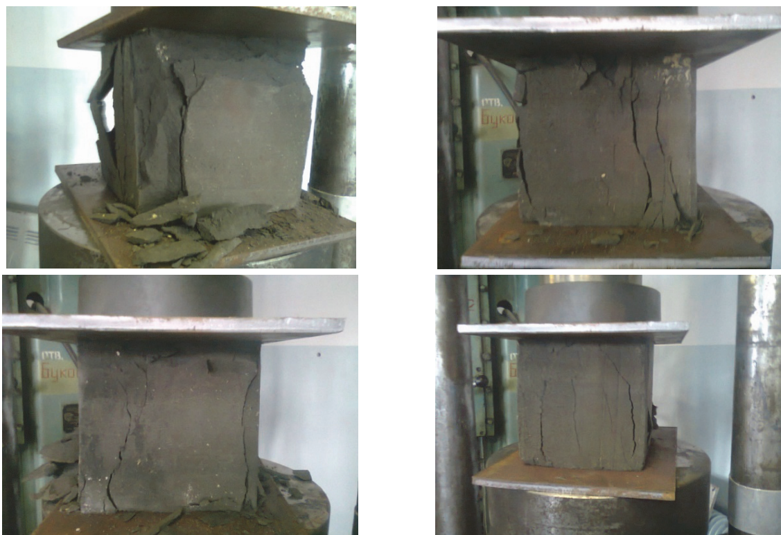
Рис. 2.6. Испытание образцов на прочность составов ХЦ с использованием лопастного смесителя
