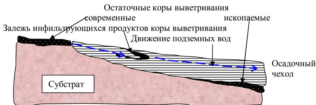
Рис. 6.2. Разрез рудного района, содержащего остаточные и инфильтрационные месторождения выветривания
