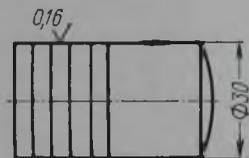
Рис. 42. Плунжер гидродвигателя
