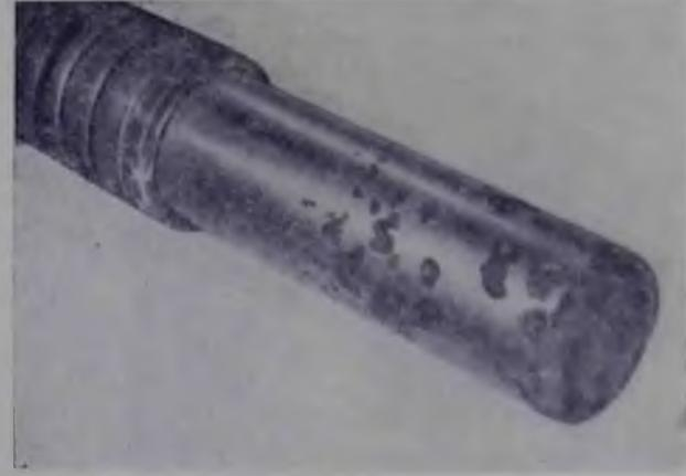
Рис. 4. Плунжер крепи МК-97, поврежденный коррозией
