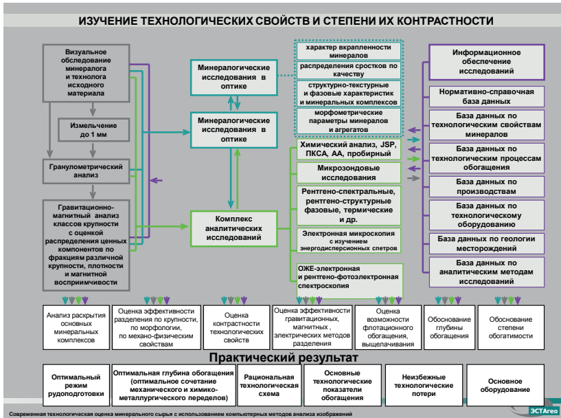
Рис. 2.20 Последовательность изучения технологических свойств минералов и степени их контрастности
