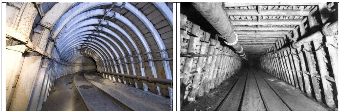
Рисунок 1. Арочная и трапециевидная крепи горных выработок
