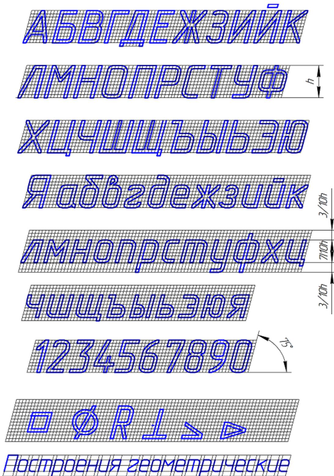
Рисунок 6. Шрифт типа Б с наклоном
