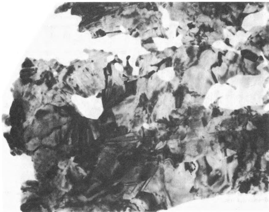
Рис. 62. Поликристаллическое строение самородного кадмия. Электронно-микроскопический снимок, увел. 90000. Южное Верхоянье
