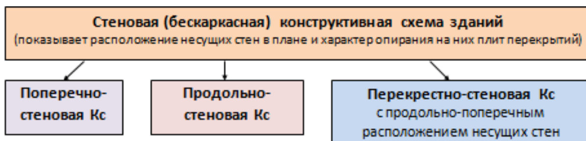
Рис. 19. Конструктивные схемы стеновых (бескаркасных) зданий
