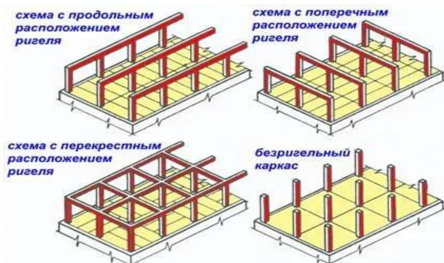
Рис. 12. Схема расположения несущих ригелей в каркасном здании [77]
