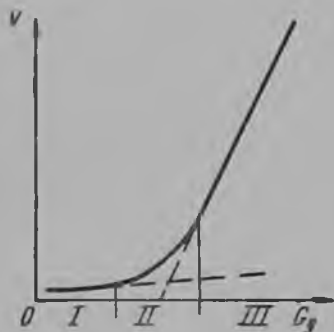
Рис. 7. Зависимость механической скорости проходки от удельной контактной нагрузки.
