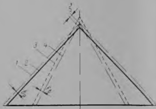
Рис. 59. К геометрическому расчету зубьев. 1 — конус ребер зубцов; 2 — конус вершин зубцов; 3 — конус впадины зубцов; 4 — конус ребер впадин.
