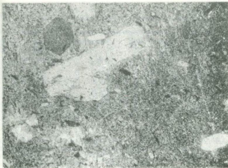
Фиг. 48. Пойкилобластическая структура канкринитового сиенита
