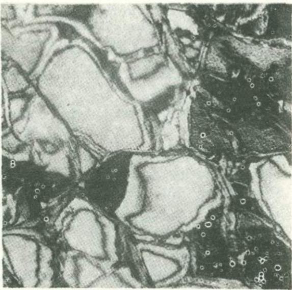
Фиг. 9. Пластинчатый магнетит, развитый по трещинам спайности оливина от темненного дунита
