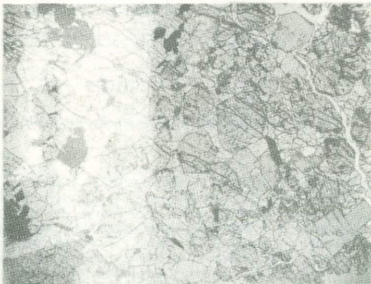
Фиг. 51. Апатит-форстеритовая порода с небольшими количествами магнетита (черное) и флогопита (пластины со спайностью). Форстерит образует изометричные зерна в зернистой массе апатита
